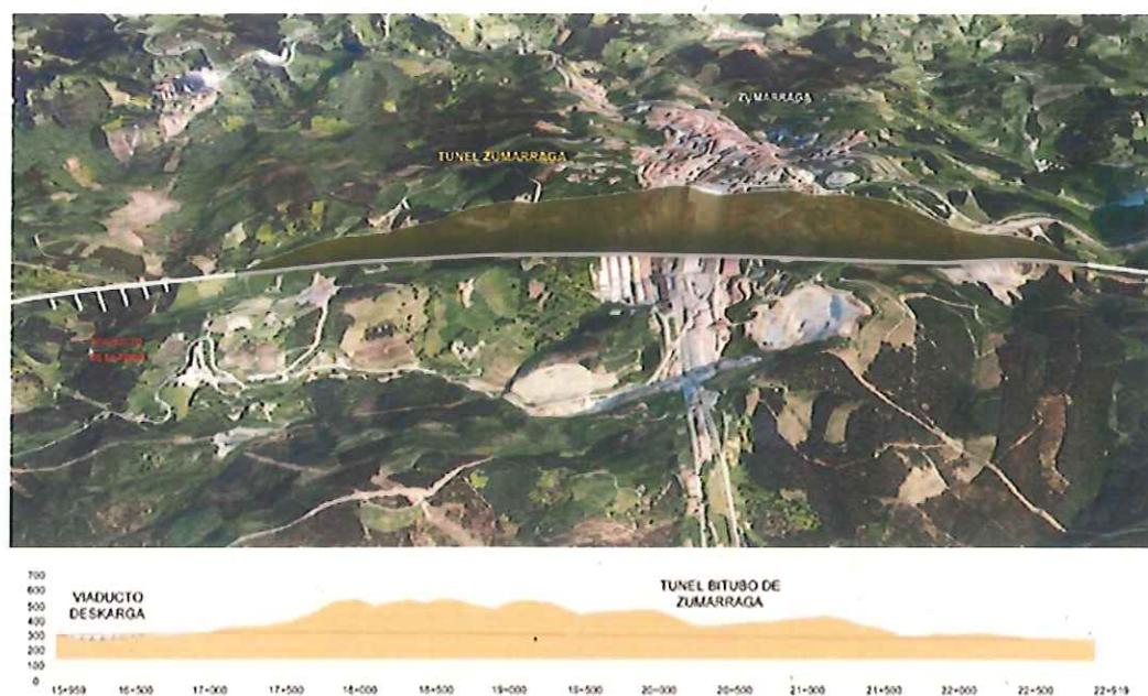
Fig. 4. Imágenes que muestran la situación espacial del túnel de Antzuola respecto a la Zumárraga en la superficie. Arriba, perfil del territorio; abajo, composición 3D que muestra un corte ideal. Ambas figuras obtenidas de http://www.ets-rfv.euskadi.eus/v86-ets9999/es/contenidos/informacion/publicaciones_ets/es_pubs/adjuntos/Libro%20Y%20VASC A%20cast%2027082012.pdf , págs. 98 y 99
